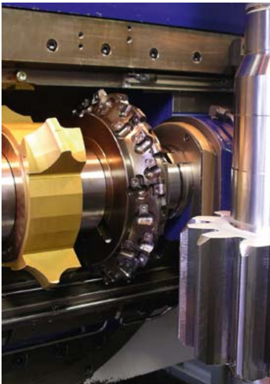
Anfasen von einer Ritzelwelle Modul 16 mit Chamfer-Cut und Vorfräsen mit HM-Zahnformfräser Chamfering of a pinion shaft, module 16, chamfer cut and pre-milling with a carbide gear milling cutter
